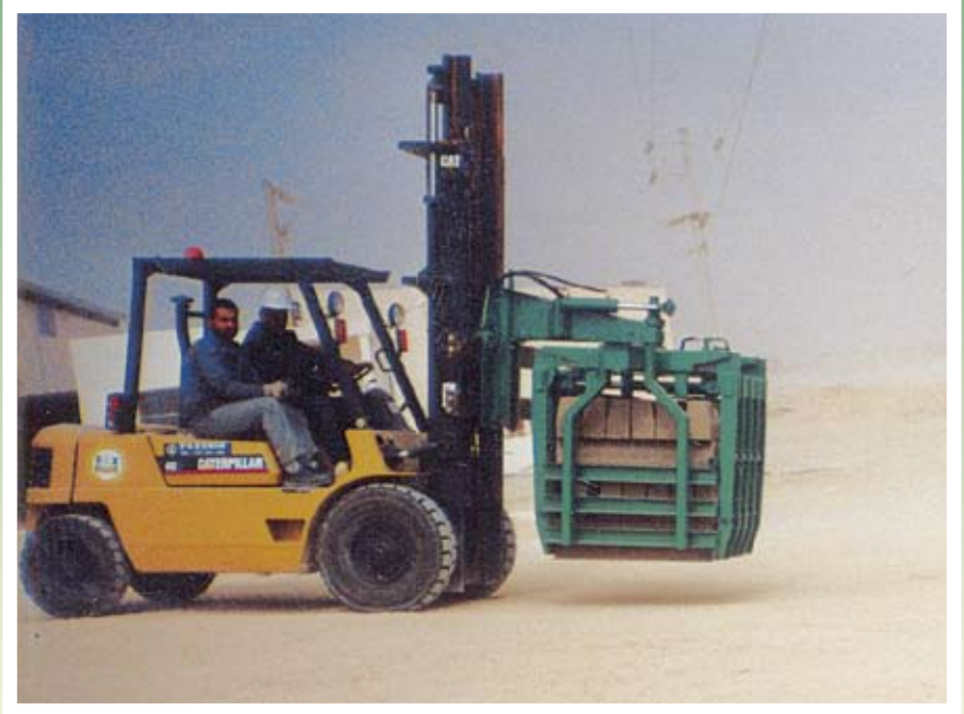
Hydraulic block clamp for cross-layers of blocks قامط هيدروليكي لتشكيل مكعبات من المصنعات مرتبة بشكل تقاطعي
